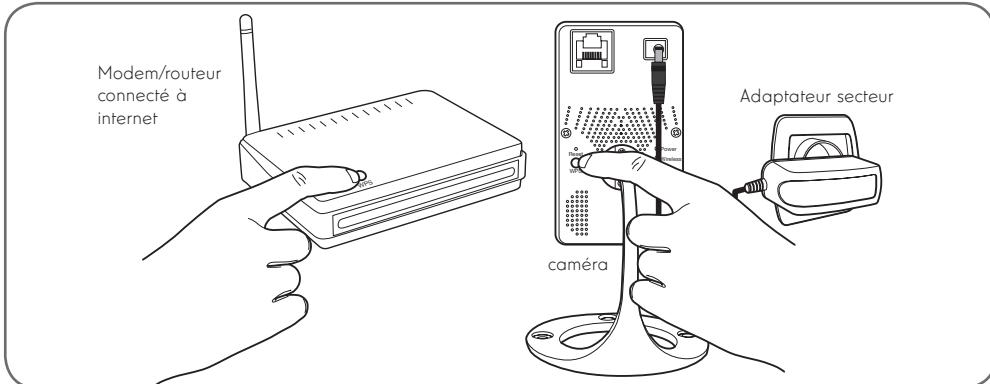
**Remarque importante :** Votre caméra n'est pas compatible avec les réseaux sans fil de fréquence 5GHz (réseau WiFi 802.11ac).
