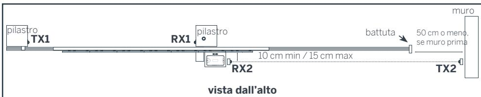
Collegando le fotocellule in questo modo, il sistema reagisce all'interruzione di uno o dell'altro raggio infrarosso durante la chiusura e del raggio del bordo secondario durante l'apertura. Non dimenticare il ponticello tra “-” e “COM”.
