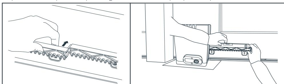
Controllare che tutta la cremagliera sia centrata sulla ruota dentata del motore. In caso contrario, regolare la posizione del motore sulla base.
