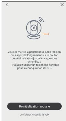
In questo passaggio la telecamera deve essere messa in tensione. Se necessario, interrompere e ripristinare l'alimentazione elettrica. La telecamera è ora priva di configurazione, toccare **Réinitialisation réussie** (Reinizializzazione riuscita) per continuare. La telecamera si accende per poi emettere una suoneria (due serie di cinque note) che indica che è pronta per proseguire l'installazione.
